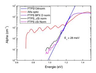
Variations de  $\alpha$  avec l'énergie des photons mesurées dans différentes conditions; alfa optic est déduit des mesures optiques; FTPS BPX D de mesures avec une diode c-Si; FTPS134 de mesures avec une diode InGaAs et un filtre optique à 746 nm; les deux courbes FTPS\_cSi avec un filtre optique en silicium cristallin et différentes conditions d'amplification du signal électrique.
